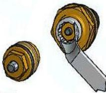
5.5. При течи из-под штока термостатического клапана, головка клапана может быть снята, отремонтирована или заменена. Головка отвинчивается с помощью гаечного ключа. Сливать воду из коллектора при этом не нужно.
