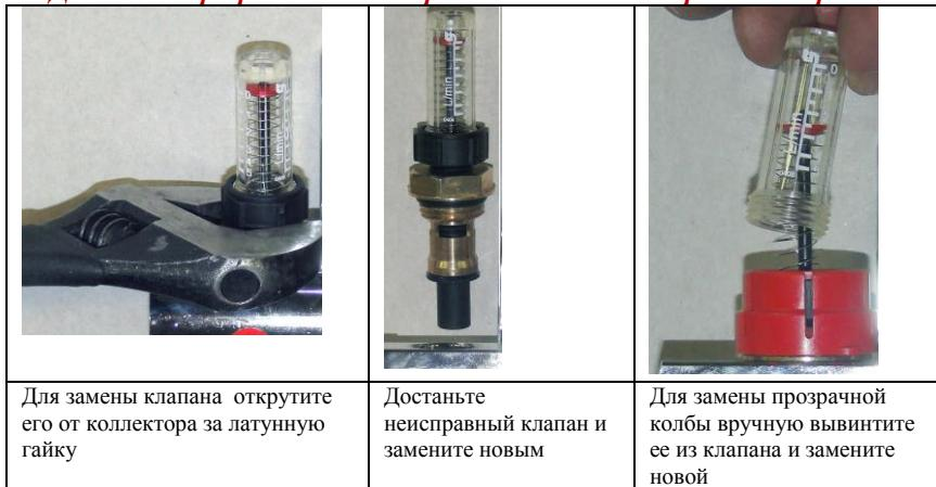
Для замены клапана открутите его от коллектора за латунную гайку
